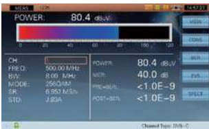
Medição de nível e qualidade de um sinal DVB-C (QAM)
